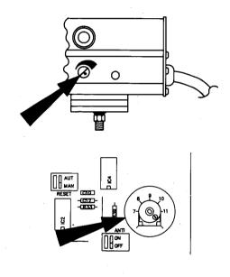
Die Verstärkung sollte nach jedem Wechsel der Fadenqualität neu eingestellt werden. Um eine möglichst grosse Abstellsicherheit zu erlangen, ist es notwendig, dass die Lichtschranke und die Signalverstärkung immer richtig eingestellt sind.
