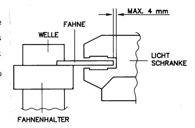
Wenn die "ANTI"-Funktion verwendet wird, ist es notwendig, eine zusätzliche Fahne anzubauen, die die Lichtschranke vor dem Übergabepunkt durchläuft. Diese zusätzliche Fahne macht es möglich, einen durch einen Fehler zuviel eingezogenen Faden zu erkennen, auch wenn dieser bei der Übergabe verloren geht.
