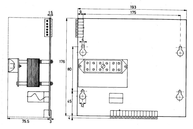
Abmessung des ELTEX-Metallgehäuses
