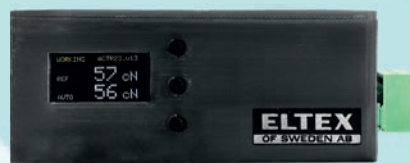
Zentraleinheit mit Tasten für Einstellungen und einem Display zur Anzeige der voreingestellten (Soll-) und der tatsächlichen Fadenzugkraft
