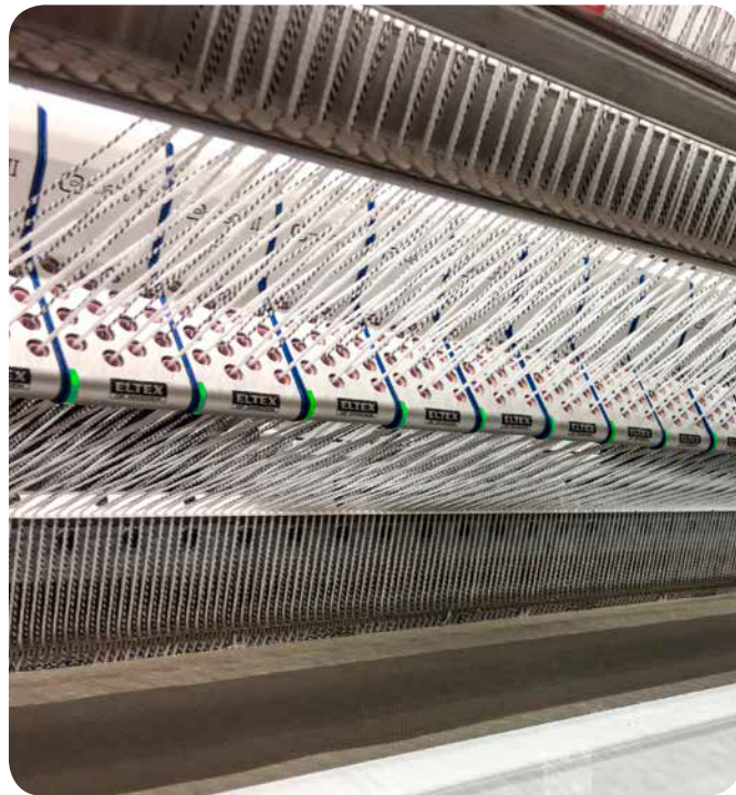
Compact II 型传感器安装于空间更为局促的簇绒织机
