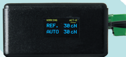
Zentraleinheit mit Tasten für Einstellungen und einem Display zur Anzeige der voreingestellten (Soll-) und der tatsächlichen Fadenzugkraft
